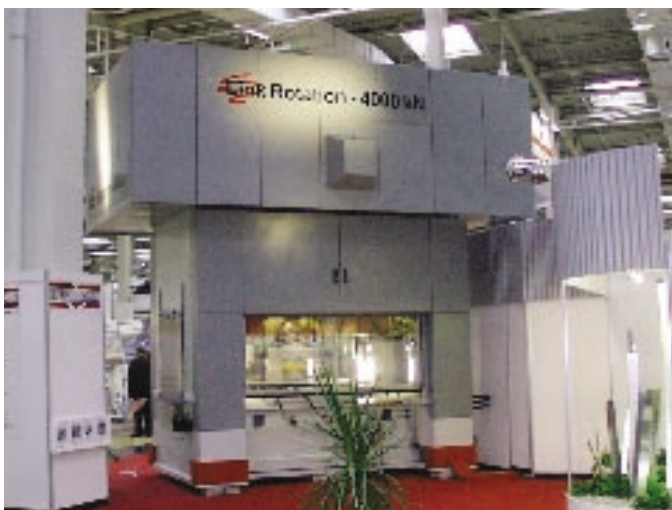
Mit Link-Rotation erfolgt die Umformung bei gleicher Hubzahl schonender als bei normalen Pressen.
