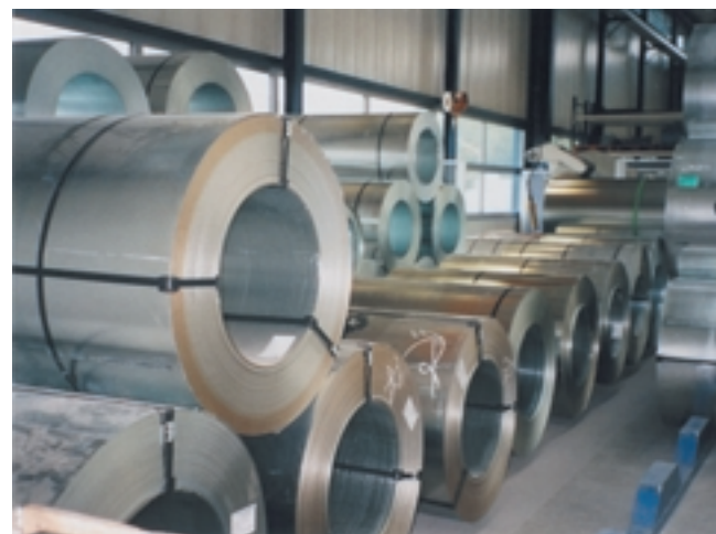
Bild 2. Triftiger Grund: Weil rund 80 Prozent der Blechmenge bei robatherm als Coil angeliefert werden, ist die Quer- und Längsteilanlage eine Schlüsselinvestition
