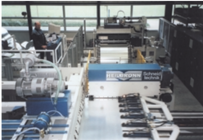
Bild 3. Wie alles beginnt: 5-t-Haspel mit automatischer Beladung und Richtmaschine (im Hintergrund), Querteilschere (mit Schriftzug) sowie Zangenvorschub (vorn links)
