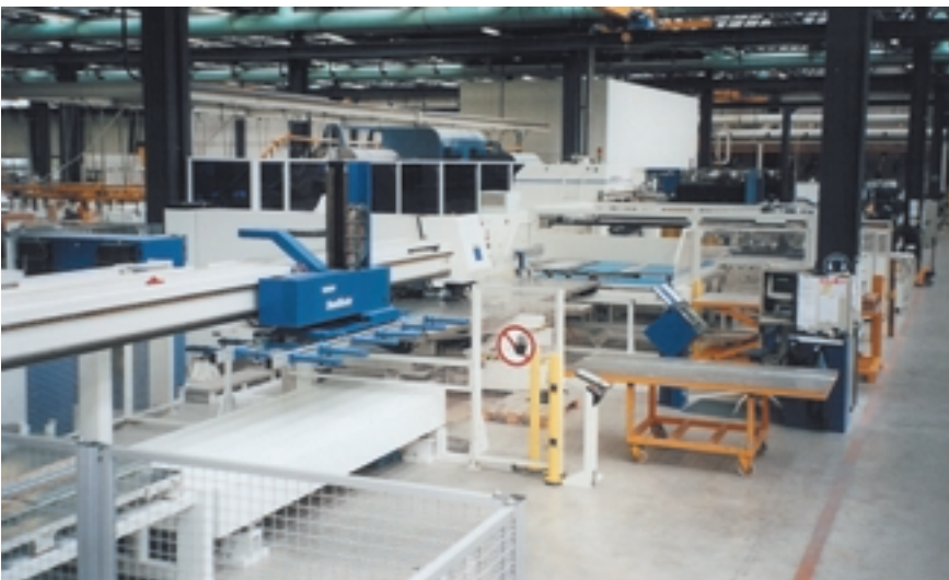
Bild 6. High-tech beim Blech: Flexibles Stanz-Biege-System für die Weiterverarbeitung der Zuschnitte
